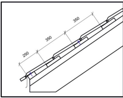
В случаях, когда требуется сместить листы металлочерепицы вверх по скату (разноуровневый карниз; допущена ошибка при снятии размеров для заказа кровельного материала; весь обрешетник, включая карнизную доску, смонтирован с шагом 350 мм) допускается решение карнизного узла с применением карнизной планки.
