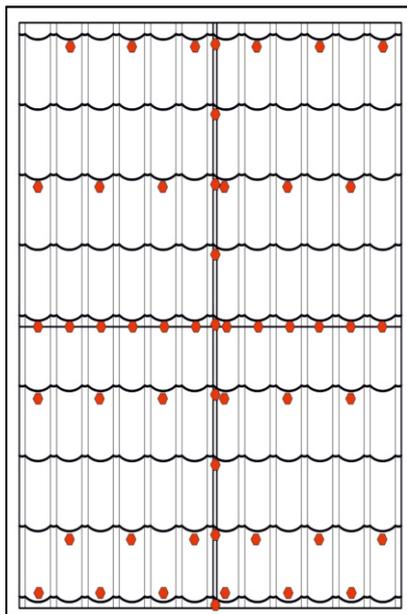
Листы металлочерепицы крепятся в прогиб волны на расстоянии 10...15 мм ниже линии штамповки. При правильно смонтированной шаговой обрешетке можно смело закручивать саморез в указанной точке крепления. Металл лежит на этой доске без зазора и при закручивании самореза лист металлочерепицы будет надежно прижат к шаговой обрешетке без деформации листа.
